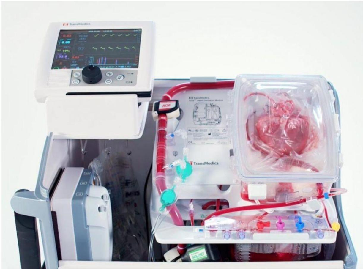
Grâce à la machine, le coeur ne s'arrête pas de battre pendant le trajet du donneur au receveur.
